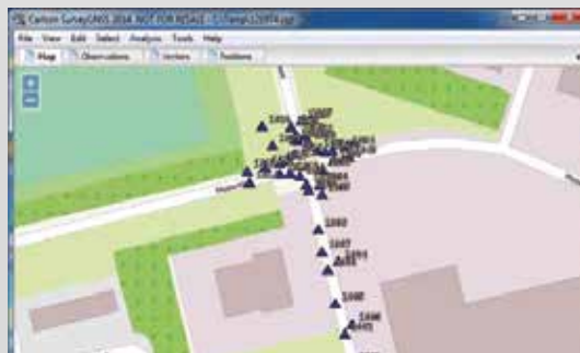
Punkty topograficzne pomierzone metodą Stop and Go
